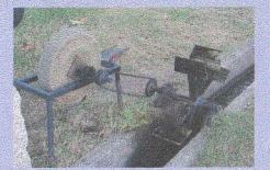
Sistema de poleas dunha serra (tamén chamada fábrica de madeira)
